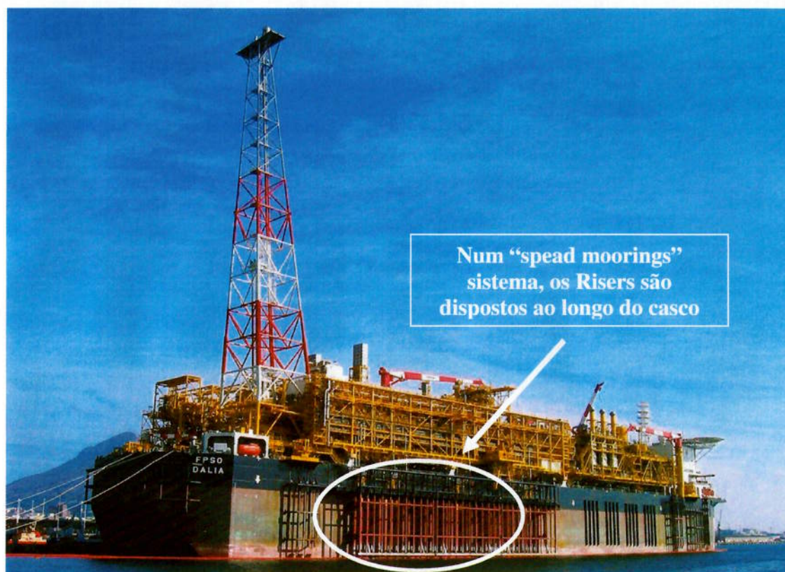
Figura 1 - FPSO Dalia com seu sistema tipo ‘ spread mooring ’
